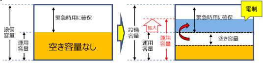
運用容量内の既連系電源に電制装置を設置し新たに電制対象とすることにより、 既連系電源の容量を、緊急時用に確保している容量側の使用に変更 上記により運用容量が拡大することになり、電力系統の更なる有効活用を図る 第37回 再生可能エネルギー大量導入・次世代電力ネットワーク小委員会(2021年11月30日)資料2から抜粋
