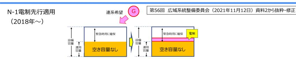
事故時には自らが電制されることを条件に、常時は使用を想定しない緊急時用に確保している容量※に新規電源を接続
