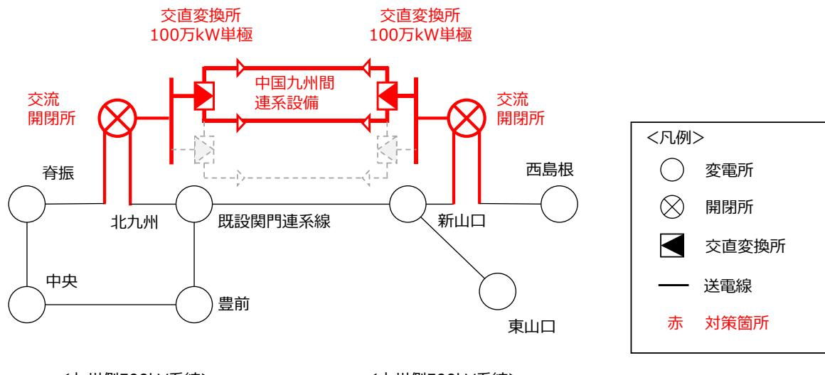
※1 交直変換所や直流送電線等の設計に将来、200万kWへ増強するための拡張性を考慮
