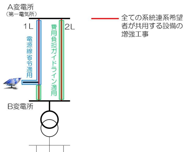
図8 電源線省令の考え方方が適用される範囲の例
