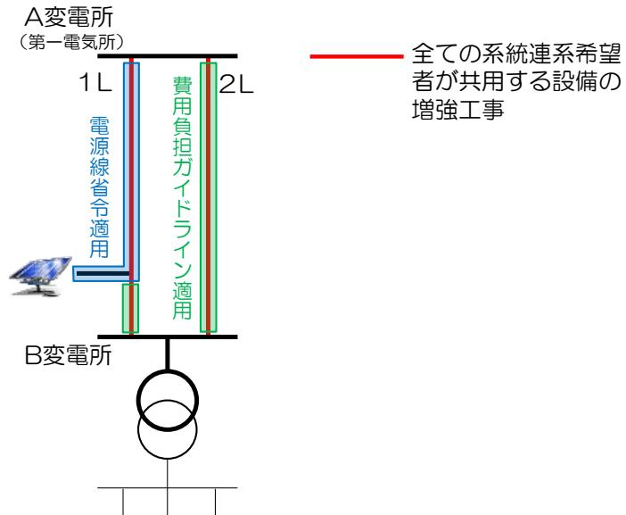
図5 電源線省令の考え方方が適用される範囲の例
