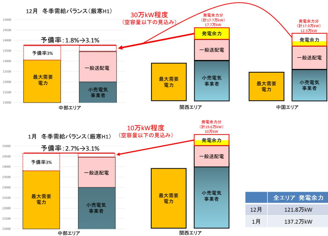
【図11 供給力を他エリアからの取引で賄う場合の試算（厳寒H1）】
