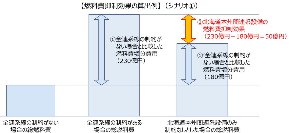
図33 燃料費抑制効果（再生可能エネルギー発電抑制解消量）の算出方法
