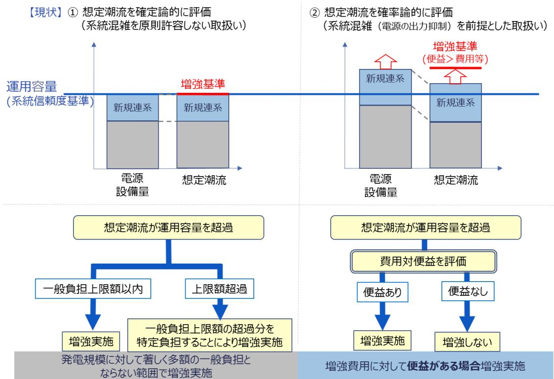
図 18 流通設備増強判断のイメージ
