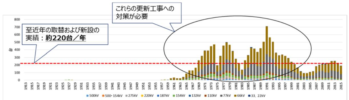
図 4 - 5 変圧器の物量分布 (66kV(一部 22kV)~500kV)
