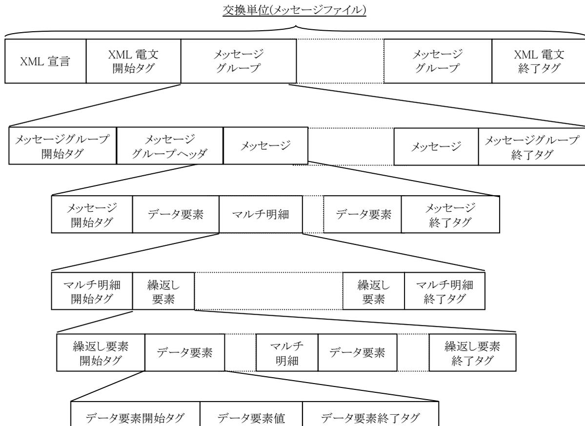
図 3-1 XML 電文の階層構造
