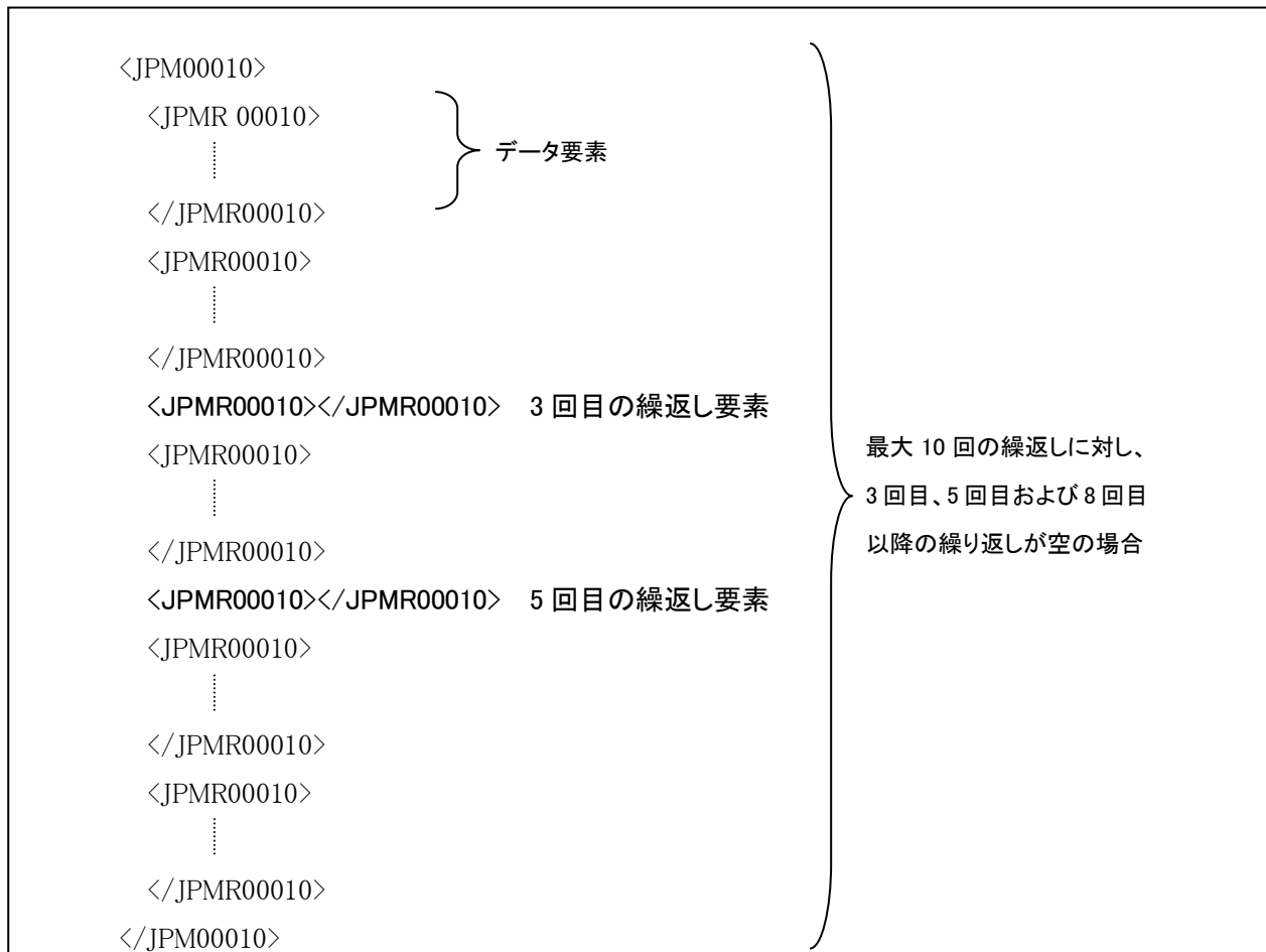
図3-5 マルチ明細構造 空繰返しの表現例
