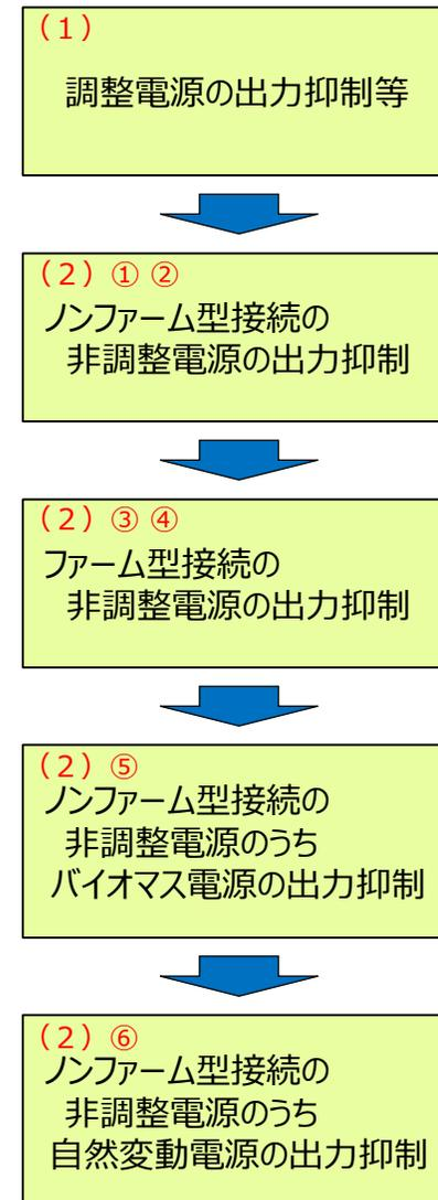
77kV西濃揖斐線の下位系統に、自然変動電源の出力抑制の前段までに出力制御ルールに基づいて制御される発電設備等がないことを確認する。
