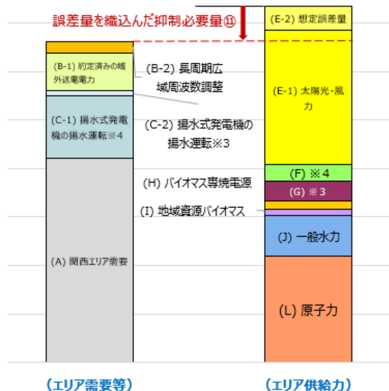
再エネの出力抑制を行う必要性と抑制必要量
