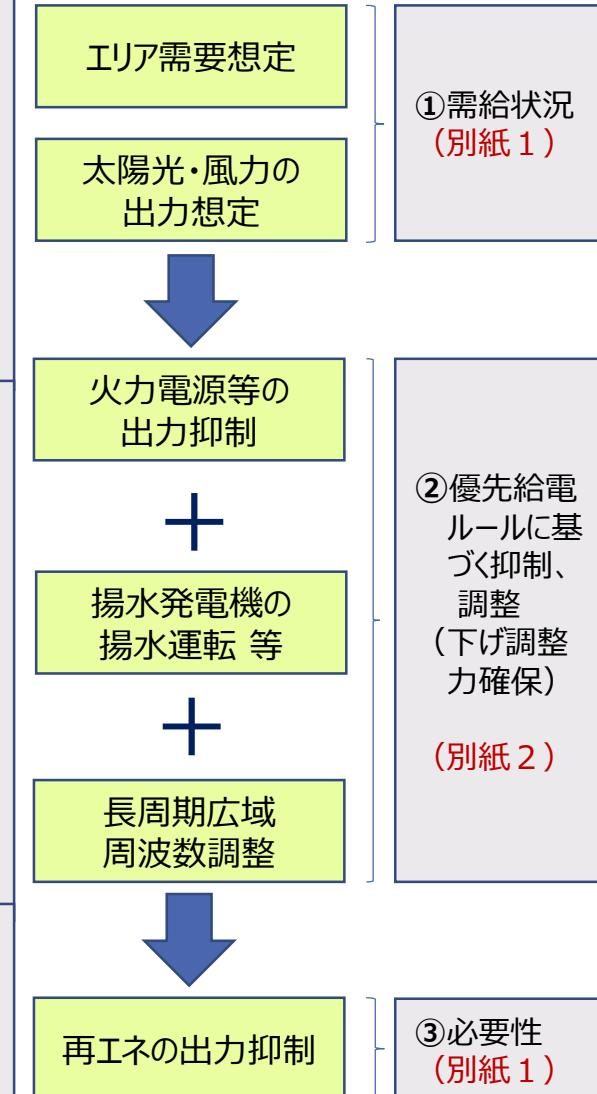
北海道電力ネットワークは、4月の以下の1日について、下げ調整力不足が発生することを想定したため、再エネ事業者に対し、出力抑制の前日指令を実施し、当日、自然変動電源（太陽光・風力）の出力抑制を実施した。
