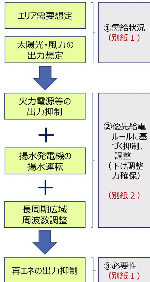
中国電力ネットワークは、2月の以下の5日間について、下げ調整力不足が発生することを想定したため、再エネ事業者に対し、出力抑制の前日指令を実施し、当日、自然変動電源（太陽光・風力）の出力抑制を実施した。
