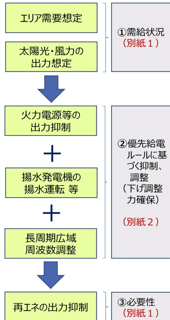
九州電力送配電は、2月の以下の13日間について、下げ調整力不足が発生することを想定したため、再エネ事業者に対し、出力抑制の前日指令を実施し、当日、自然変動電源（太陽光・風力）の出力抑制を実施した。
