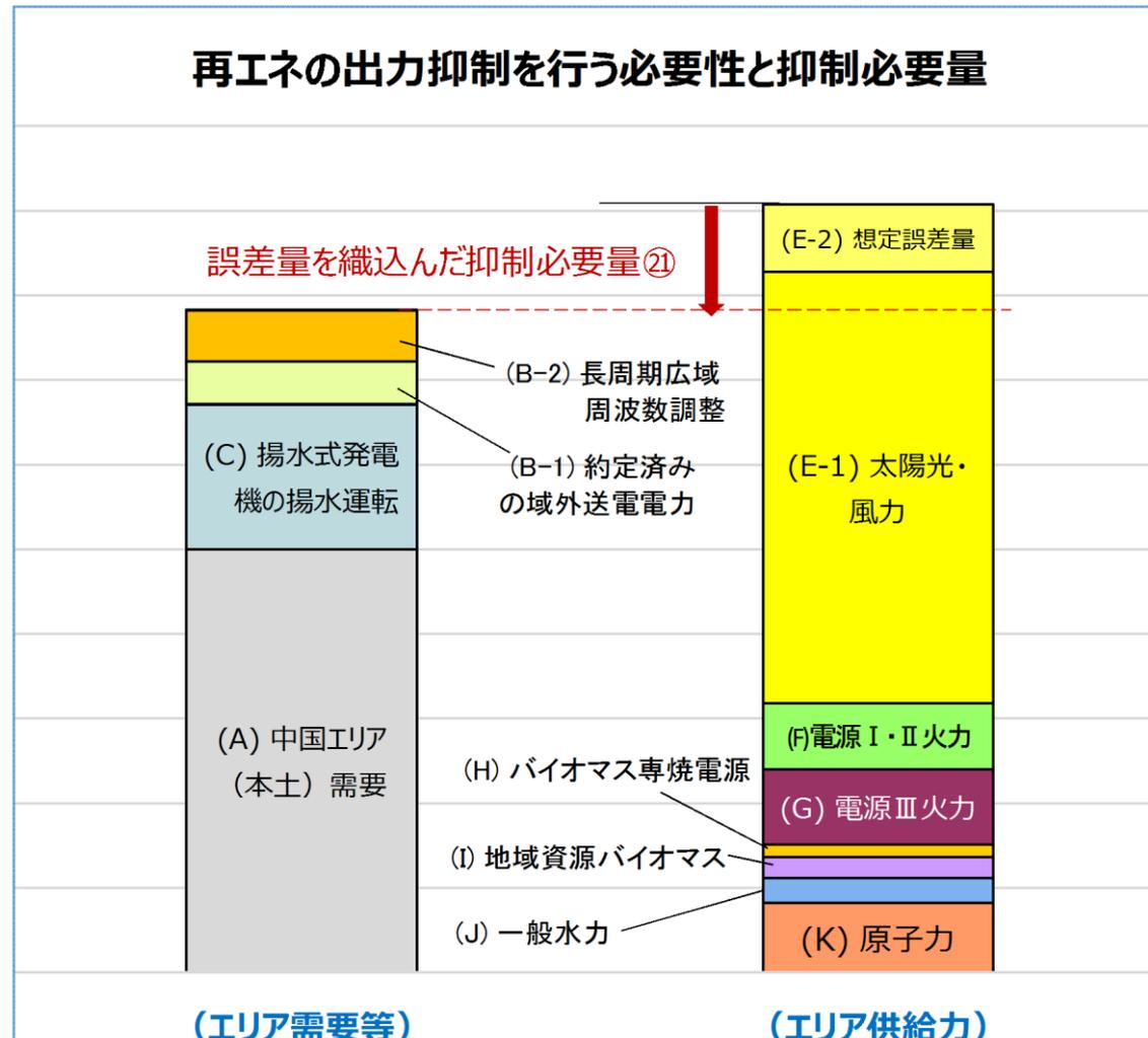
中国電力ネットワークは、優先給電ルールに基づく、中国エリア内の電源Ⅲ等発電所の出力抑制について、49者の発電事業者に対して、優先給電ルールへの理解を求めるとともに、出力抑制指令への確実な対応を要請している。
