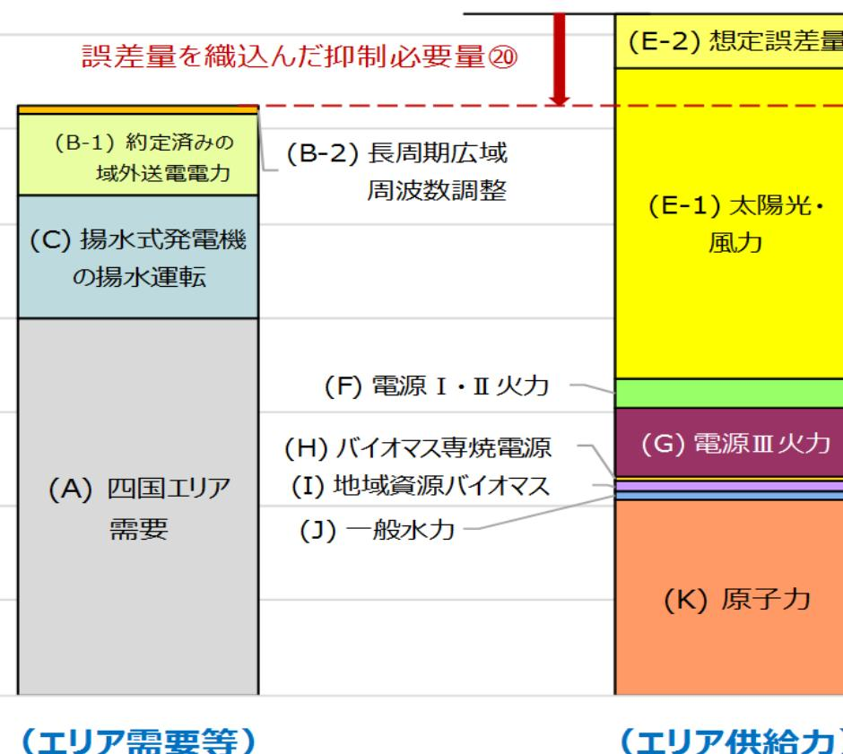
四国電力送配電は、一層の連系線活用による再エネ出力制御量の低減をはかるため、四国エリアの再エネ出力制御が見込まれる場合に、本四連系線の運用容量を120万kW（熱容量）から145万kW（短時間熱容量）に拡大するためのシステム開発を行い、2021年10月より運用を開始している。
