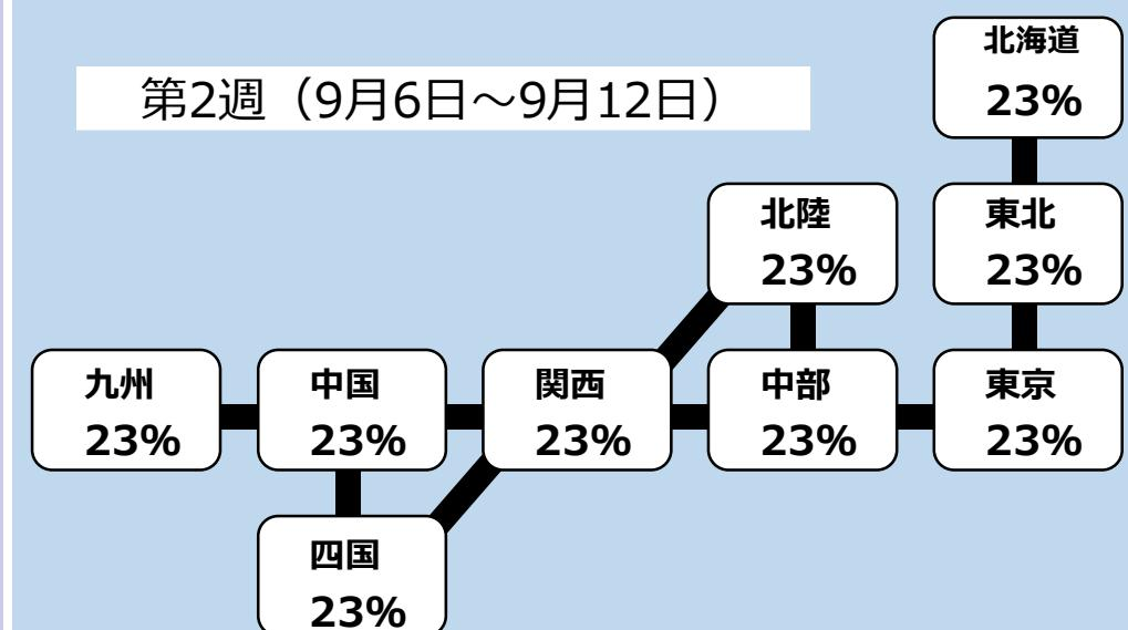
・kWh余力率は連系線の空容量の範囲で、極力同一の余力率となる電力融通の実施を想定したものであり、空容量が十分にあれば、同一のkWh余力率となる。
