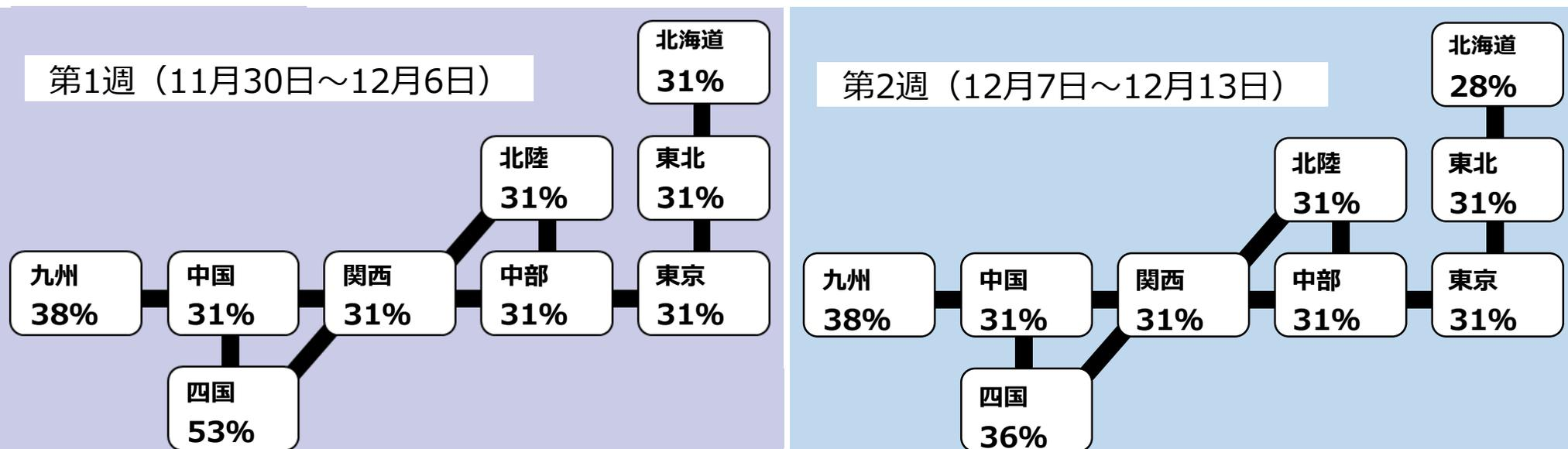
・ kWh余力率は連系線の空容量の範囲で、極力同一の余力率となる電力融通の実施を想定したものであり、空容量が十分にあれば、同一のkWh余力率となる。
