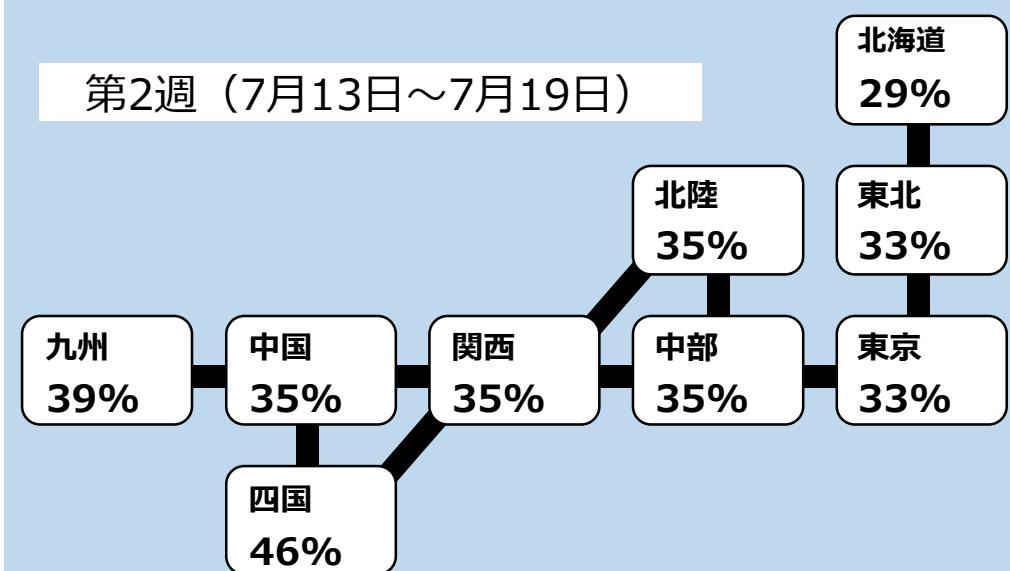
・kWh余力率は連系線の空容量の範囲で、極力同一の余力率となる電力融通の実施を想定したものであり、空容量が十分にあれば、同一のkWh余力率となる。
