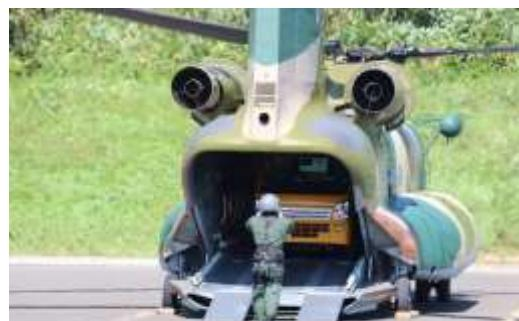
大型ヘリコプター（CH-47J）へ空輸対応型低圧応急用電源車「灯（ともす）」積載状況
