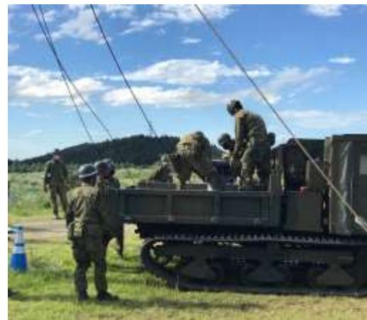
不整地運搬車による変圧器運搬
