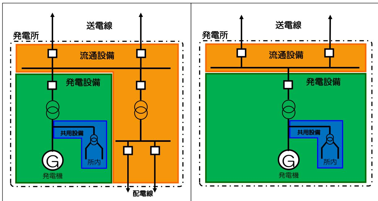
図3 発電所の設備区分（概略図）
