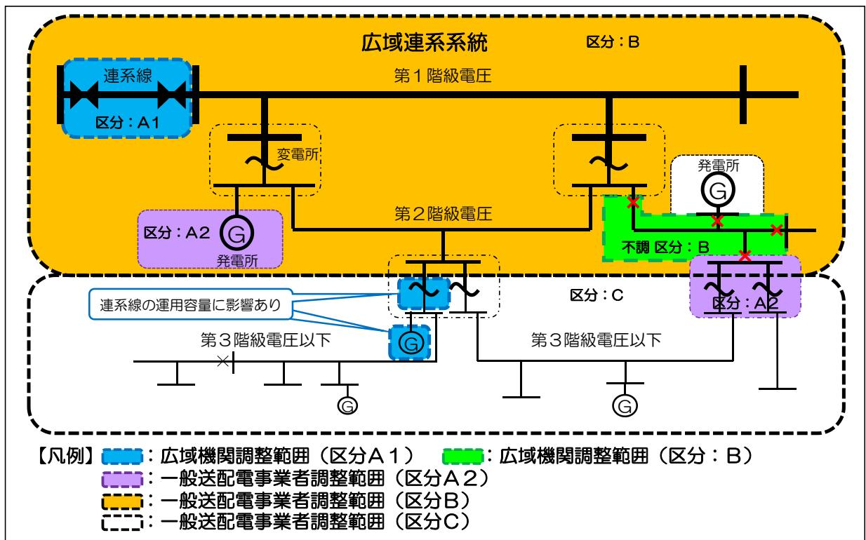
図2 作業停止計画の区分（概略図）
