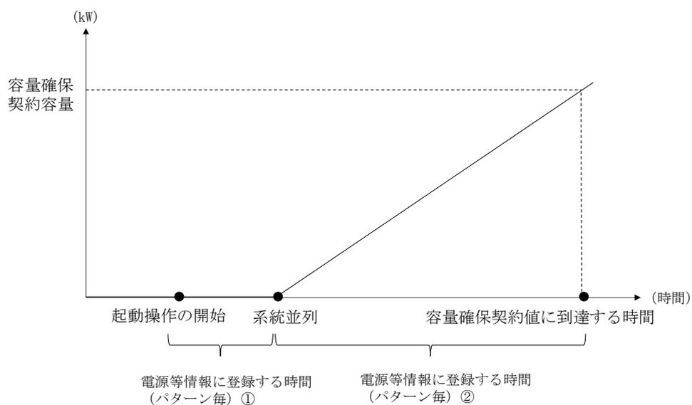
図 3-7 電源の起動時間のイメージ
