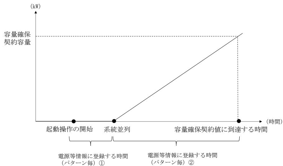
図 2-26 電源の起動時間のイメージ
