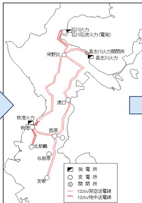
宋野比～牧港を結ぶ西側ルートを構築し、既設東側ルートと合わせて2ルート化。
