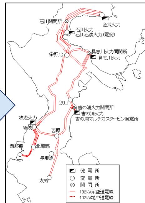
石川火力と具志川火力を連系するルートの構築により、発電所間を2ルート化。
