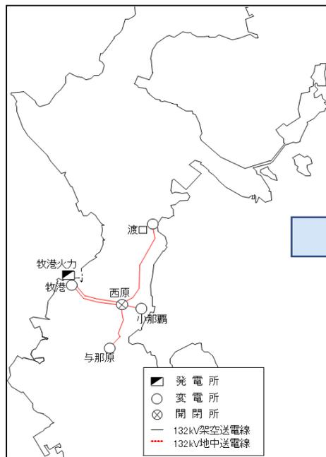
当初の132kV基幹系統は沖縄本島西海岸に位置する牧港火力から送電する放射状系統。
