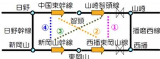
左図のとおり、関西中国間連系線は、フェンス潮流により管理しているため、市場取引時点の計画潮流①と、実際のフェンス潮流(MAX(①,②,③,④))は異なる
