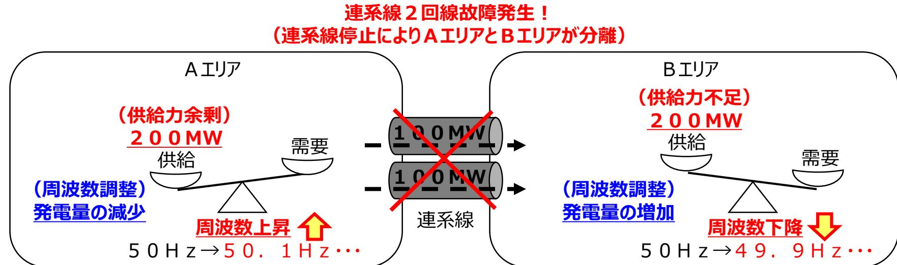
※周波数の上昇が大きく、エリアの調整力（ガバナーフリー、LFC、揚水等）で周波数を調整できない場合は、電源制限（発電機の停止）等の方法を取り大規模な停電を回避する。
