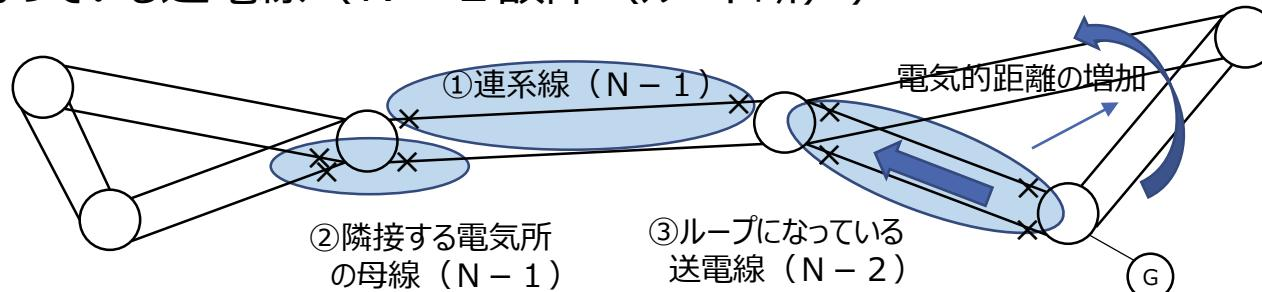
1) 連系線及び隣接する電気所の母線故障については、 $N - 2$  故障は連系線分離となり、周波数維持要因となるためここでは考慮しない。但し、連系線が2ルートでループとなっている箇所は連系線分離とならず、連系線の $N - 2$  故障（ルート断）を想定する。
