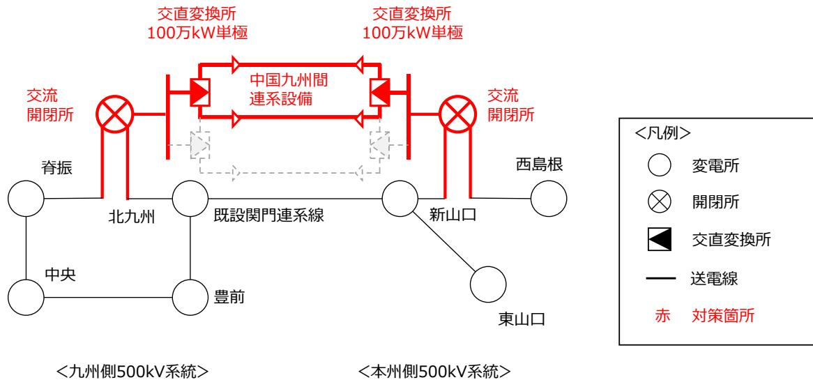
※1 交直変換所や直流送電線等の設計に将来、200万kWへ増強するための拡張性を考慮。
