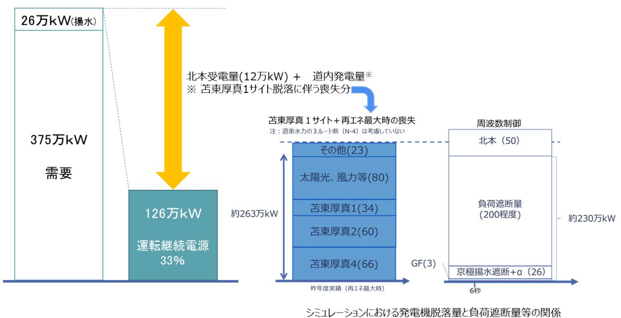
なお、本ケースのシミュレーション結果、周波数低下により風力・太陽光が脱落しても、UFRによる負荷遮断だけでなく、再エネ高出力対応用の揚水が自動遮断されるためブラックアウトを回避できることを確認している。(図表4-13参照)
