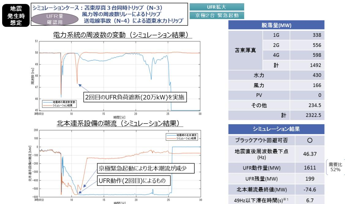
さらに、実際に発生する可能性のある苦東厚真1サイト同時トリップ（N-3）についてもシミュレーションでブラックアウトが回避できることを確認している。（図表4-10参照）
