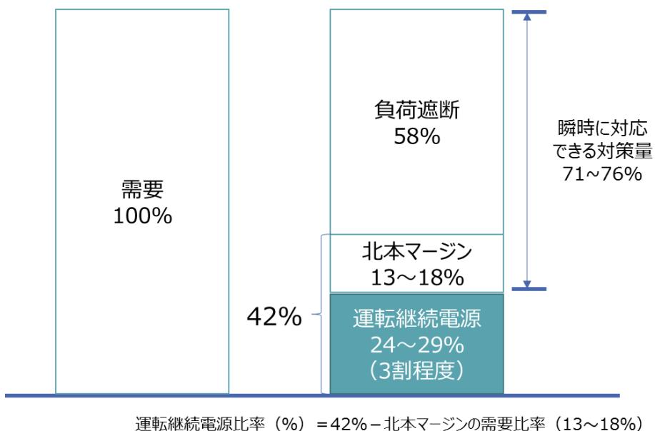
図表 4－1－2 再エネ高出力時に確保すべき運転継続電源の割合
