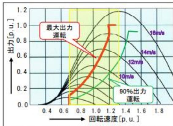
図 2.1 可変速度機の回転速度ー出力特性(例)
