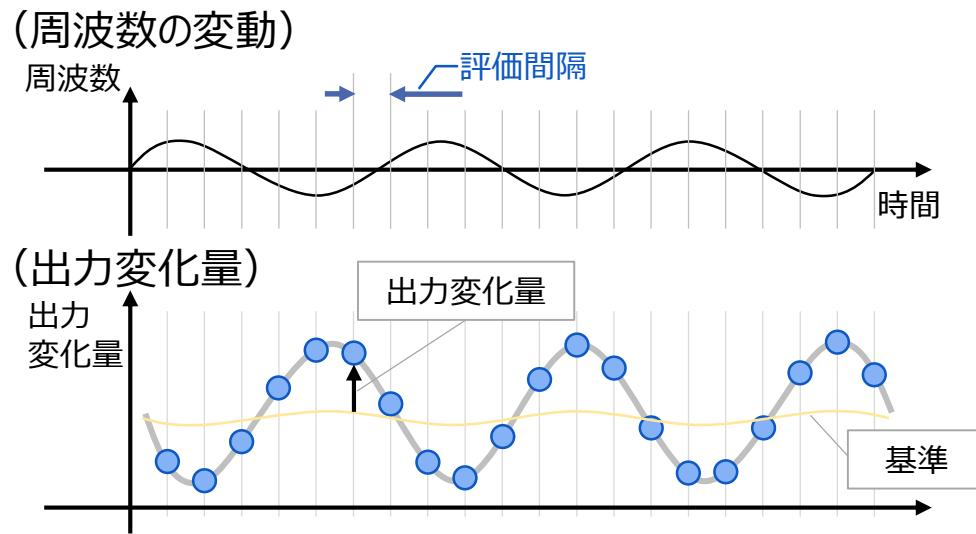
近似線の傾きが調定率の傾きと同方向にあることを確認
