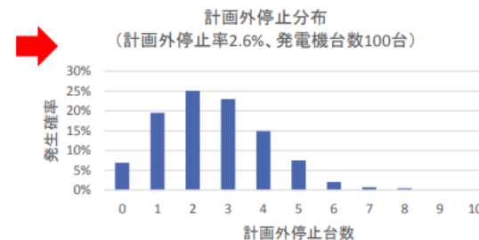
【火力の例】 計画外停止率をもとに、 二項分布にて確率分布を模擬
