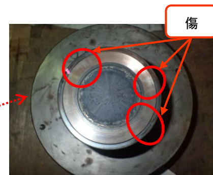
不具合状況 (弁内部部品傷つき)
