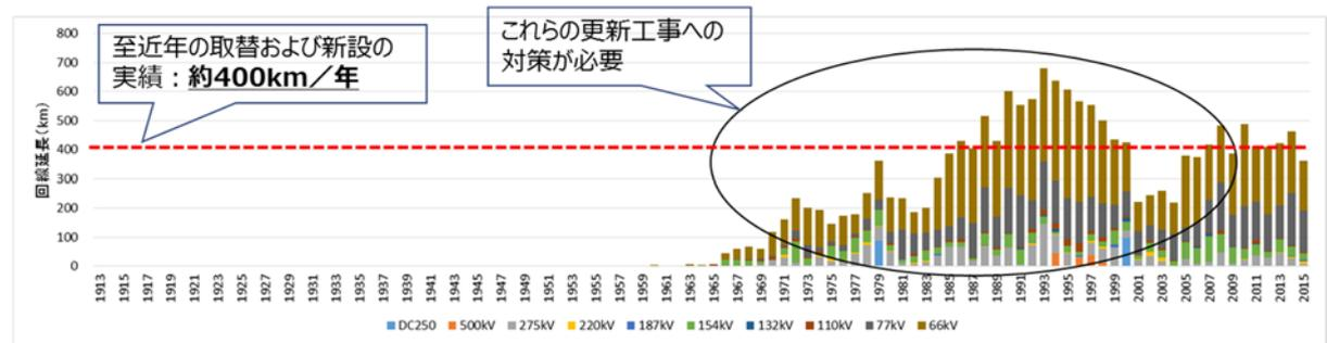
図 4 - 4 地中線の物量分布 (66kV~500kV)
