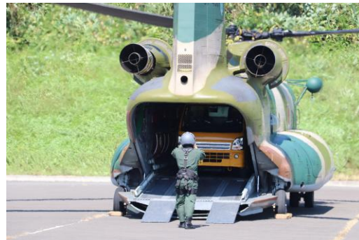
大型ヘリコプター（CH-47J）へ空輸対応型低圧応急用電源車「灯（ともす）」積載状況
