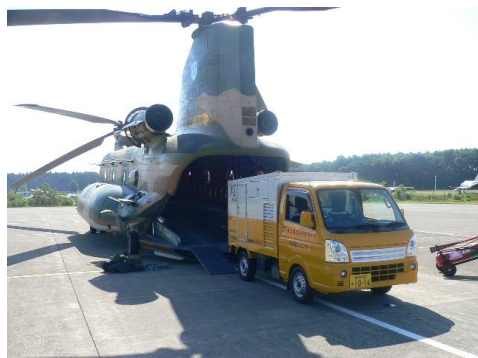
大型ヘリコプター（CH-47J）へ空輸対応型低圧応急用電源車「灯（ともす）」積載状況
