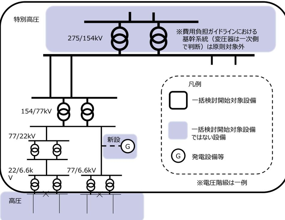
一括検討開始の対象となり得る設備（以下「一括検討開始対象設備」という。）は特別高圧の送電系統（送電線や変圧器等の設備。特別高圧と高圧を連系する変圧器を含む。図参照）となります。なお、効率的な系統整備の観点等から、以下の設備は、一括検討開始の対象となり得る設備の対象外とします。
