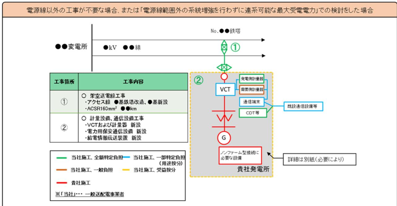
連系方法：●●kV●●線No. ●鉄塔より2回線分岐し、貴社発電所の受電設備と接続する。
