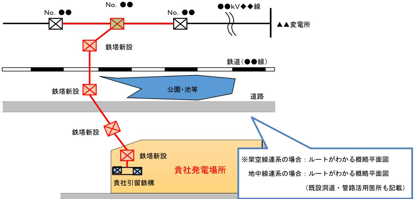
(b) 工事概要図（ノンファーム接続の場合、対象設備の制御概要も含む）
