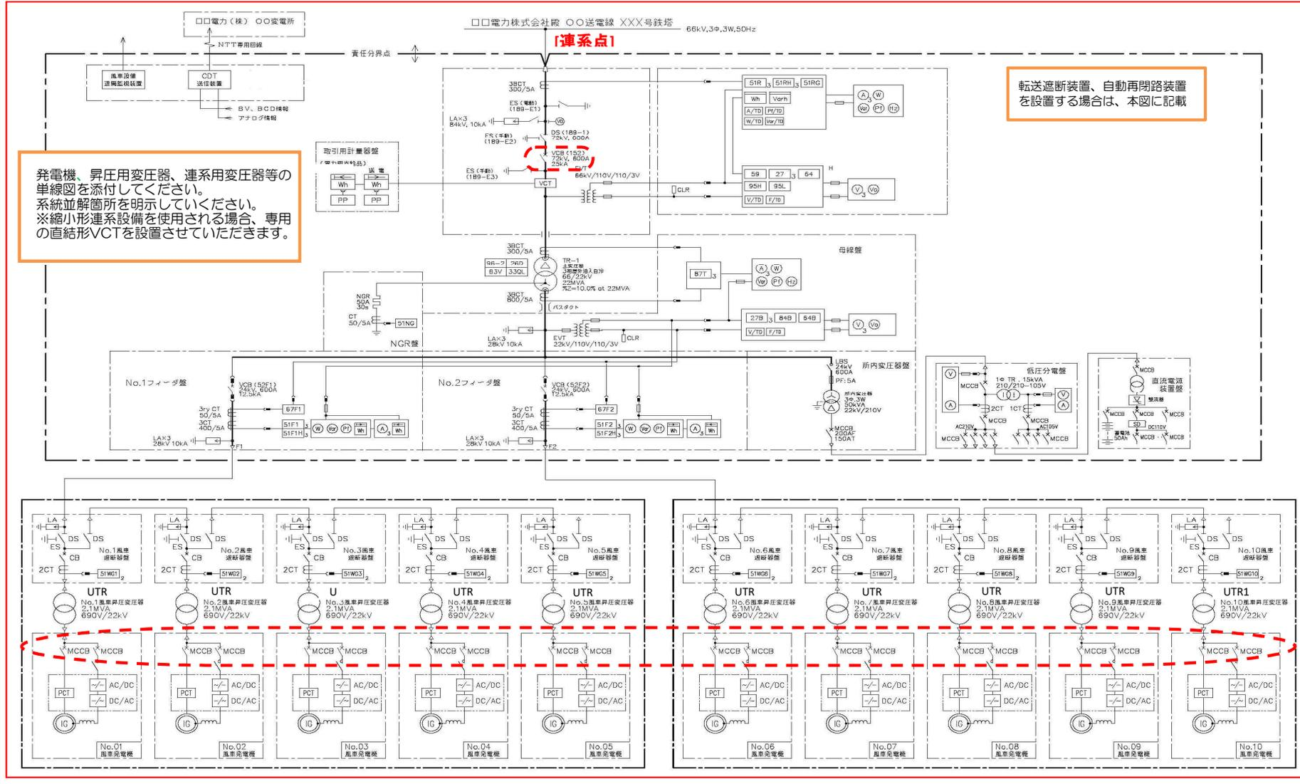
発電機、昇圧用変圧器、連系用変圧器等の単線図を添付して下さい。系統並解箇所を明示して下さい。※縮小形連系設備を使用される場合、専用の直結形VCTを設置させていただきます。
