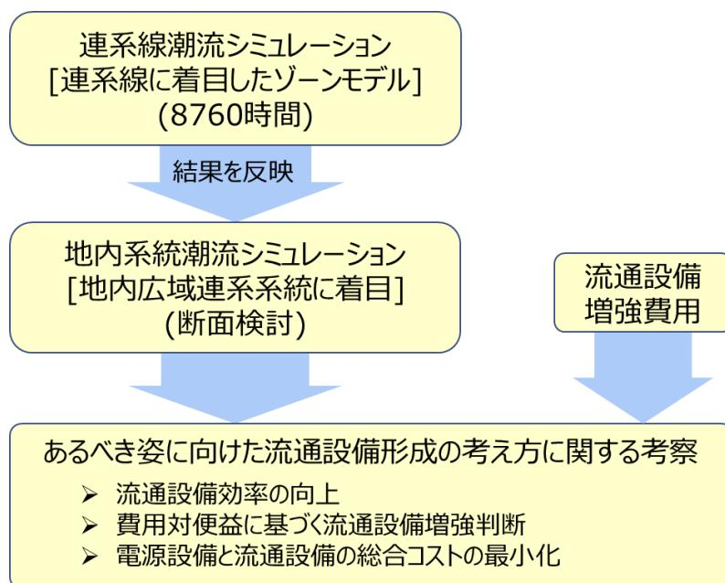
図28 電力潮流シミュレーションの概要
