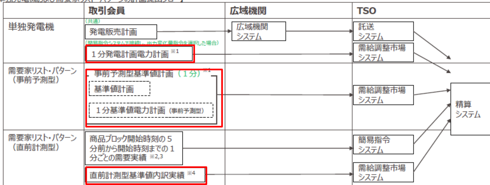
【単独発電機および需要家リスト・パターンの計画提出フロー】
