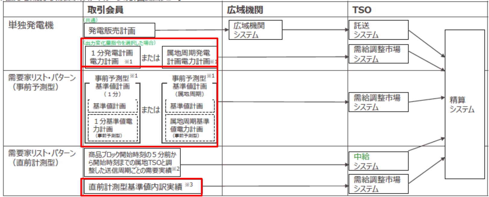
【単独発電機および需要家リスト・パターンの計画提出フロー】
